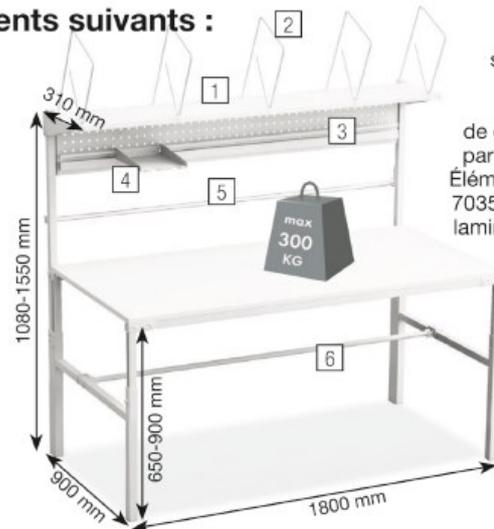
Matériaux soigneusement sélectionnés, exécution haut de gamme, revêtu par poudre époxy. Éléments acier RAL 7035. Plateau table laminé, ép. 25 mm, mélaminé des deux faces.
